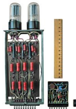
Уменьшение размеров ячеек ЭВМ первого – третьего поколений (в каждой из них – по два триггера)
